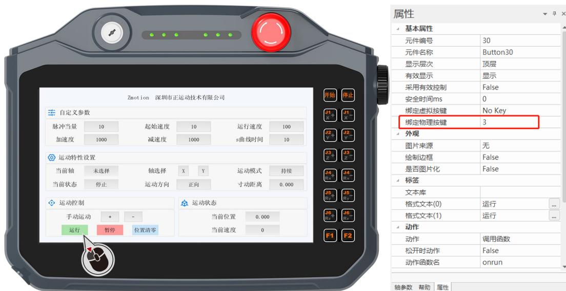
2. 重新下载程序运行，设置“自定义参数”，在轴选后，可通过按示教盒上“开始”“停止”按键代替点击触摸屏上按键，去控制所选轴的运动和停止。在显示屏上的“运动状态”窗口可显示当前轴的位置和速度。
