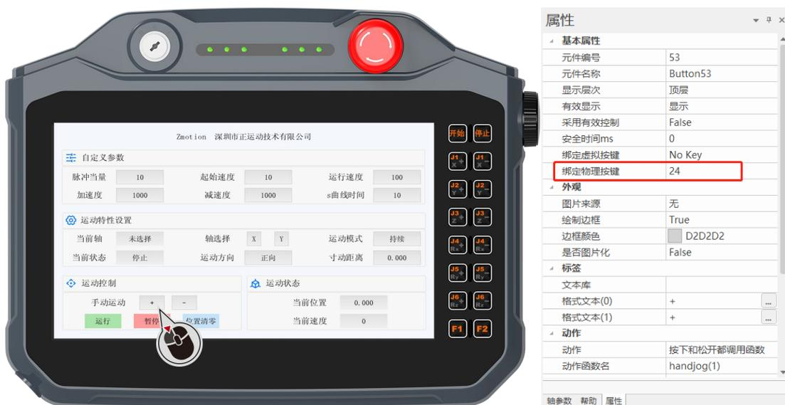
2. 重新下载程序运行，设置“自定义参数”，在轴选后，可通过按示教盒上手动运动“X+”“X-”按键代替点击触摸屏上“X+”“X-”按键，去控制所选轴的正向运动和负向运动。该运动为触发式运动，即当施
