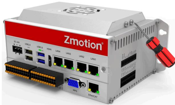
3. 在上述两步操作均已完成后，将风扇的电源线正确连接到直流 24V 电源上，其启停功能将由温控开关自动控制。（当外壳温度达到  $45^{\circ}\text{C}$  ( $\pm 3^{\circ}\text{C}$ ) 时启动散热，温度回落至约  $30^{\circ}\text{C}$  ( $\pm 5^{\circ}\text{C}$ ) 时停止运行）
