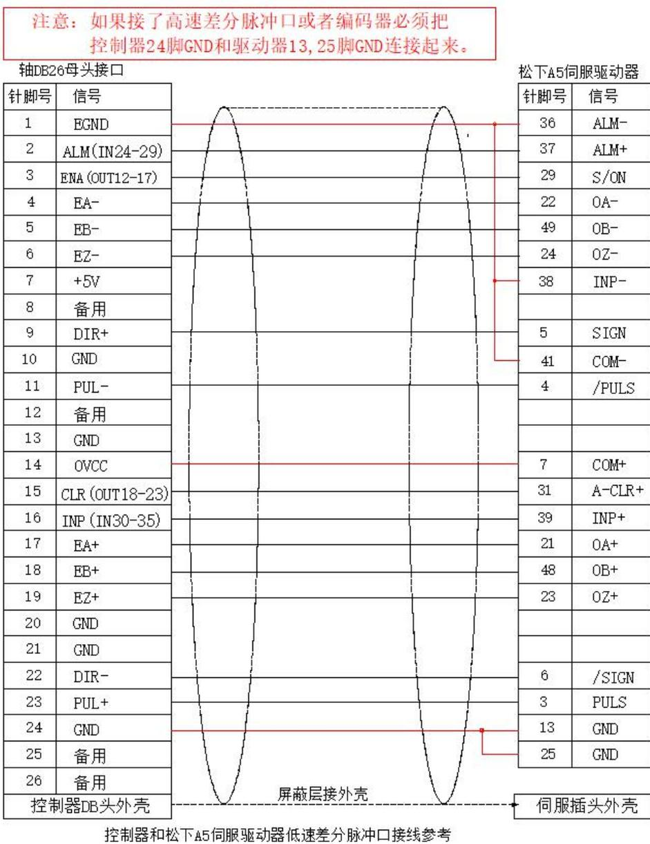
**!** 如果接了高速差分脉冲口或者编码器必须把 GND 和驱动器 25 脚 GND 连接起来。
