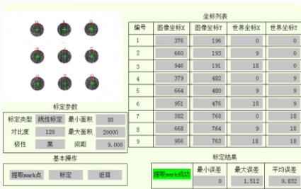
典型应用：视觉定位的偏移纠正、长度、面积测量等。
