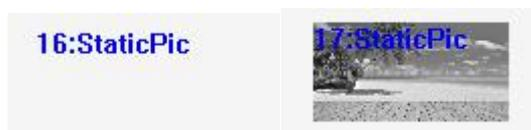
在使用视觉的时候，图片元件支持使用视觉拍摄的图片，在“背景图片”中选择视觉通道，支持三个视觉通道：@ZV0、@ZV1、@ZV2，使用前先将图片存入视觉锁存通道才能获取显示。
