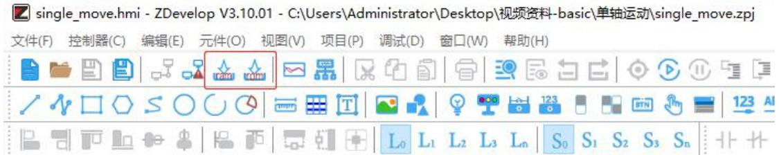
下载程序时可选择“下载到 RAM”或“下载到 ROM”，下载成功“命令与输出”窗口打印下载成功提示，同时程序下载到控制器并自动运行。
