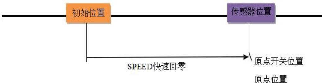
方式 5: mode=11, Z 信号模式, 轴以 CREEP 速度运行, 遇到限位开关不停止, 继续以 CREEP 速度方向运行直到 Z 信号出现。
