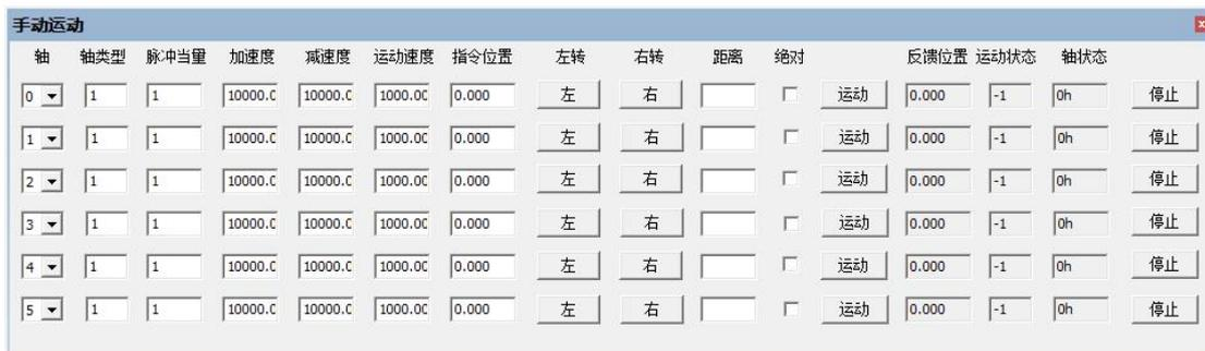
操作方法：按住“左”/“右”不放，电机持续运动，松开停止。“指令位置”显示当前发出的脉冲 DPOS（单位为 UNITS）。填写“距离”参数，点击“运动”，勾选“绝对”时，电机运动到距离参数位置；不勾选“绝对”时，电机按距离参数继续运动。
