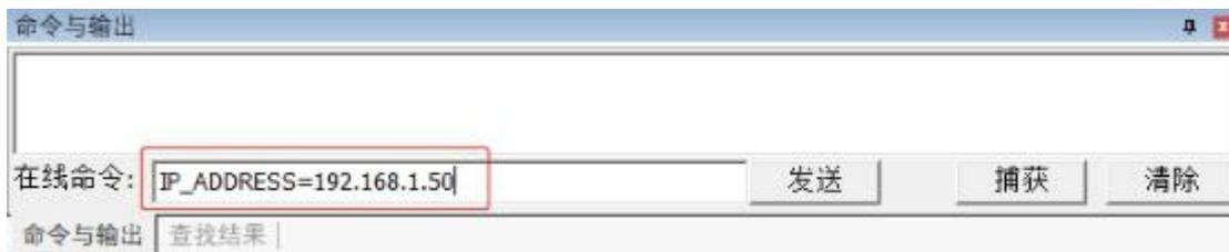
修改 IP 后，控制器与 ZDevelop 的连接会断开，此时再次选择新设置的 IP 地址连接即可。
