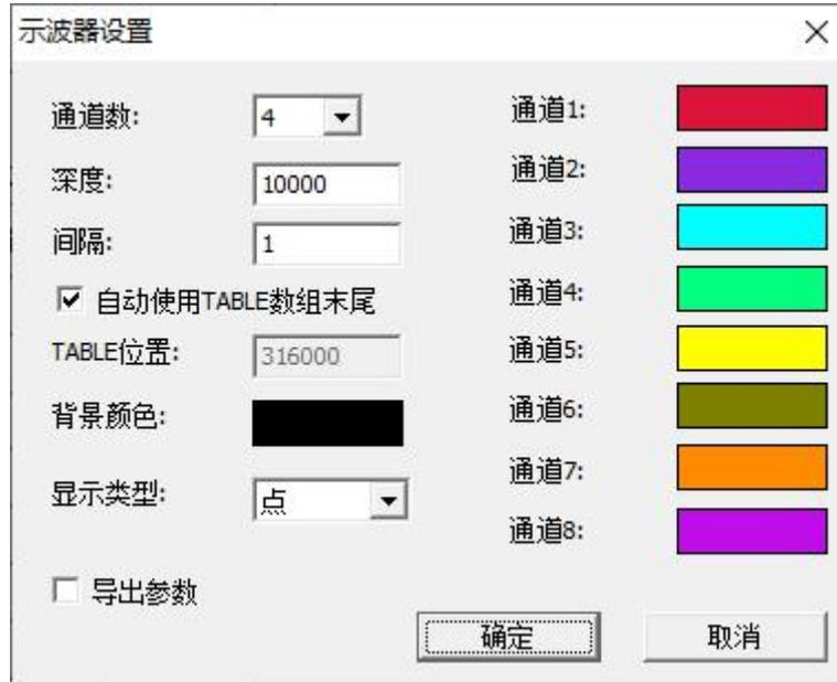
导出参数显示数据更加完整，通道配置类型、采样时间等也一并记录下来导出。
