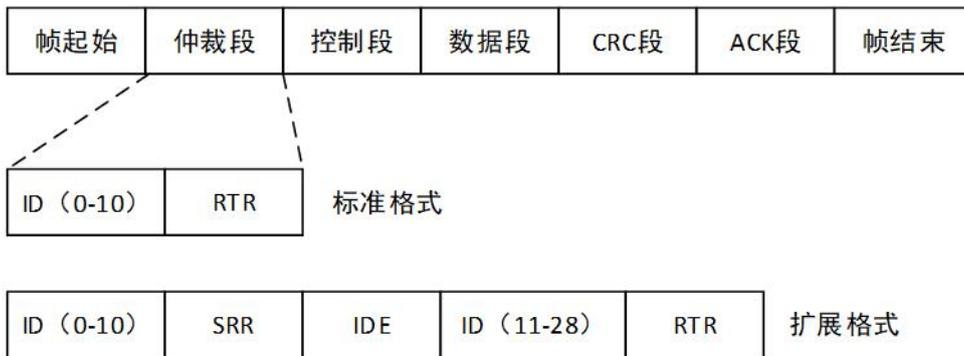
3) 控制段：控制段由 6 位组成，包括 2 个保留位（r0、r1 各占 1bit，总是用隐性电平填充）及 DLC（4 位数据长度码，占 4bit），允许的数据长度值为 0~8 字节。
