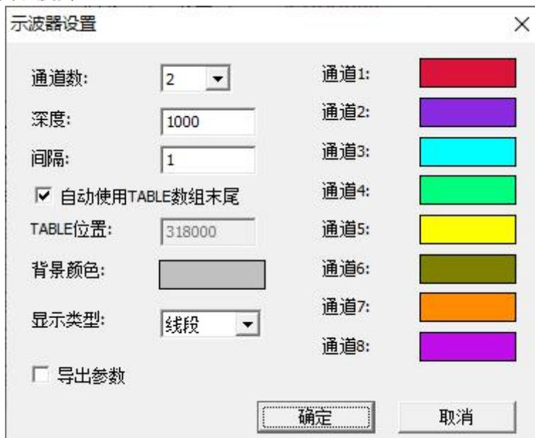
将深度调小之后采样时间较短，只能采集到部分波形。
