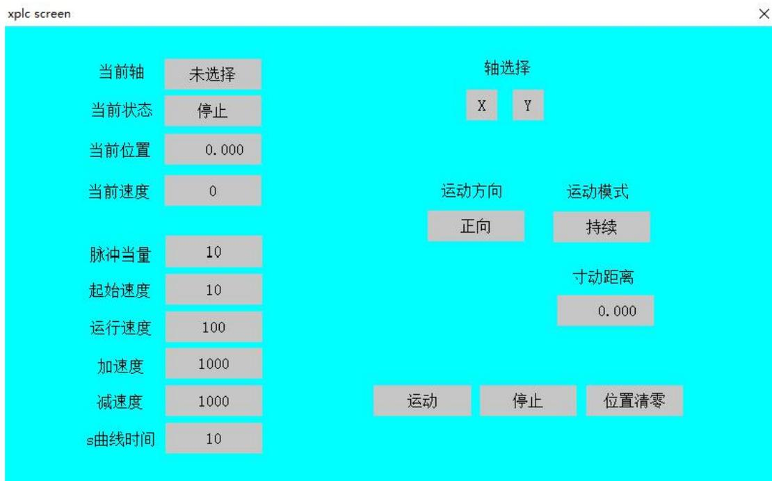
点击界面上的灰色按钮，即可模拟触摸屏设置，下图以设置脉冲当量为例，自定义数值输入后确认，轴实际运动时将会按照此参数运动。
