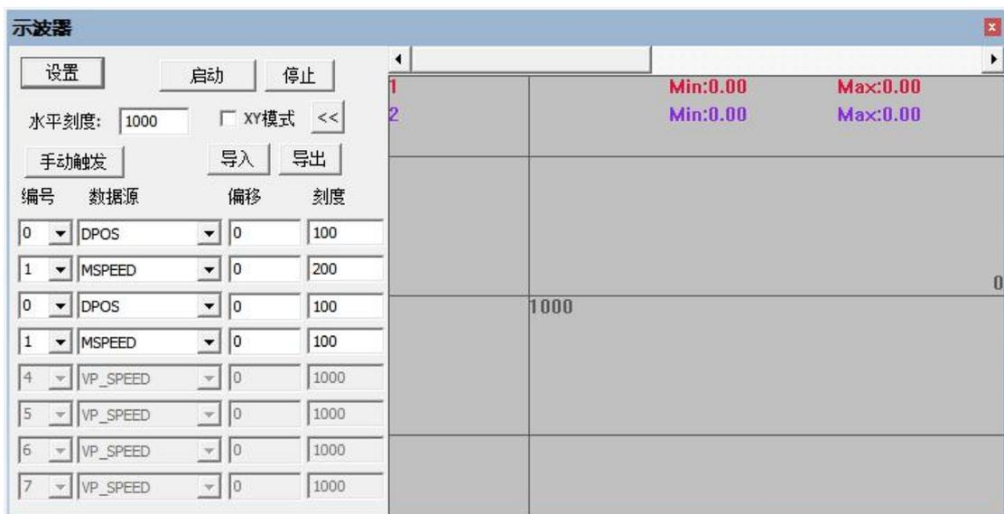
若要设置示波器参数，如轴编号、数据源以及启动设置，要先停止示波器再设置，点击“设置”按钮，弹出如下所示“示波器”设置窗口。
