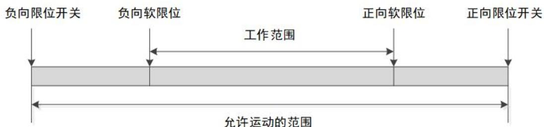
硬限位开关是限制轴的最大“允许行进范围”的限位开关。硬限位开关是物理开关元件，硬限位开关由指令映射到相应输入开关信号上，根据开关信号是常开还是常闭确定是否要对信号进行翻转，设置完成后，碰到硬限位开关，对应轴立即停止运动，停止减速度为FASTDEC。
