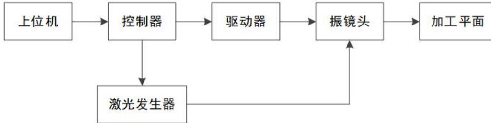
振镜系统的由以上几个部分组成一个基础系统，其中振镜头主要元件为 X/Y 两个反射镜片、分别控制 X/Y 镜片旋转的两个电机，根据实际需求还可加入人机操作系统、编码器等。
