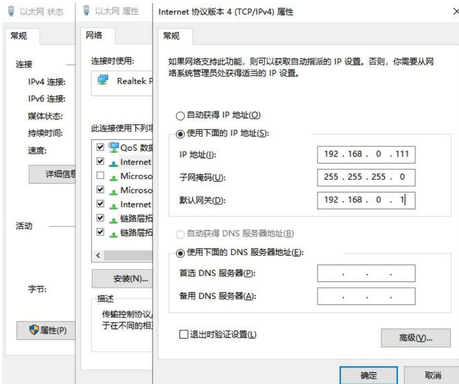
如果控制器 IP 被修改，不处于 192.168.0.XXX 这个网段，此时只能先通过串口连接控制器，然后在“控制器”-“控制器状态”来获取控制器 IP 地址，修改本机 IP 或控制器 IP，或控制器 IP 使二者处于同一网段。
