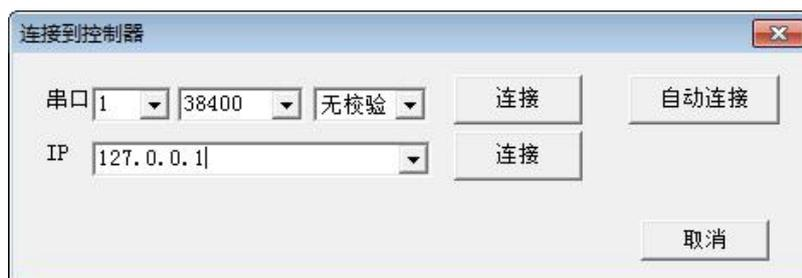
控制器串口默认波特率为 38400，数据位 8bit，无校验，停止位 1bit。根据这个在设备管理器里设置好 PC 端口参数。
