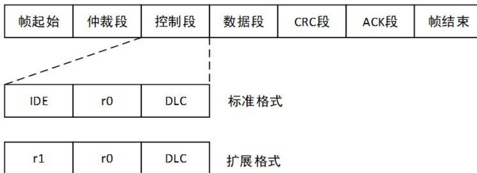
4) 数据段：发送缓冲区中的数据按照长度代码指示长度发送。对于接收的数据，同样如此。一个数据帧传输的数据量可为 0~8 字节，每个字节包含 8 位，传输时首先发送的是 MSB（最高位）。
