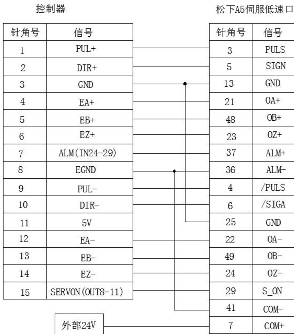
ZMC304 控制器和松下 A5 伺服驱动器低速差分脉冲口接线参考
