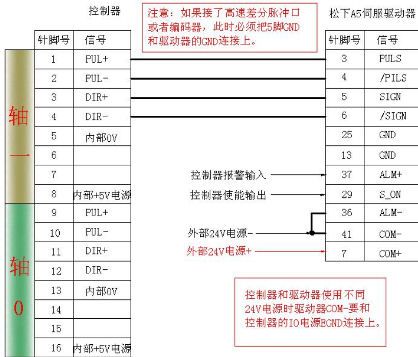
与松下 A5 伺服低速差分脉冲口连接
