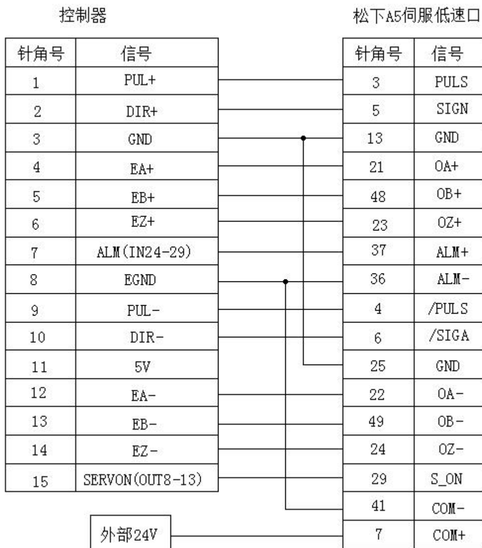
与松下 A5 伺服低速差分脉冲口连接
