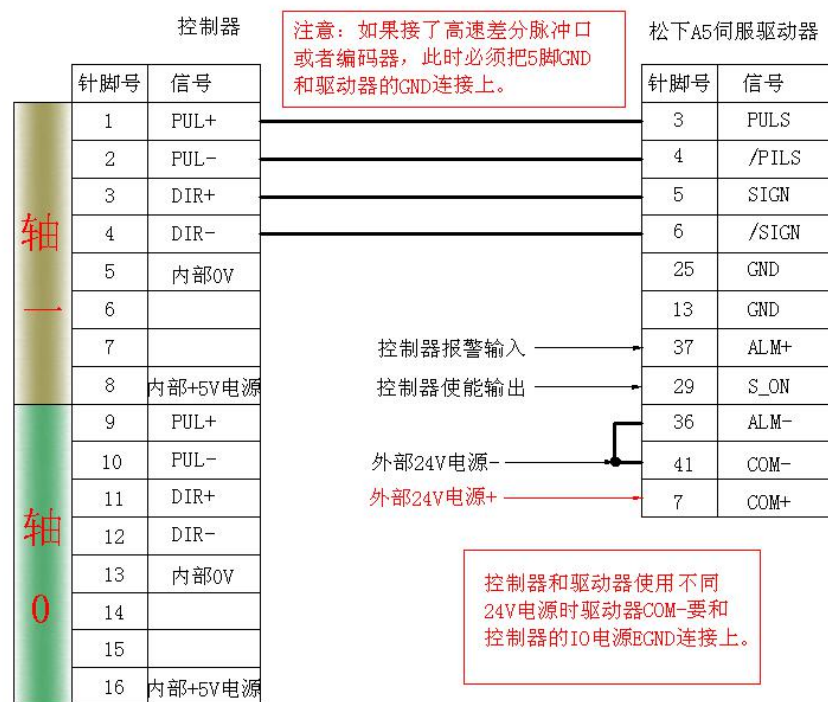
与松下 A5 伺服低速差分脉冲口接线参考
