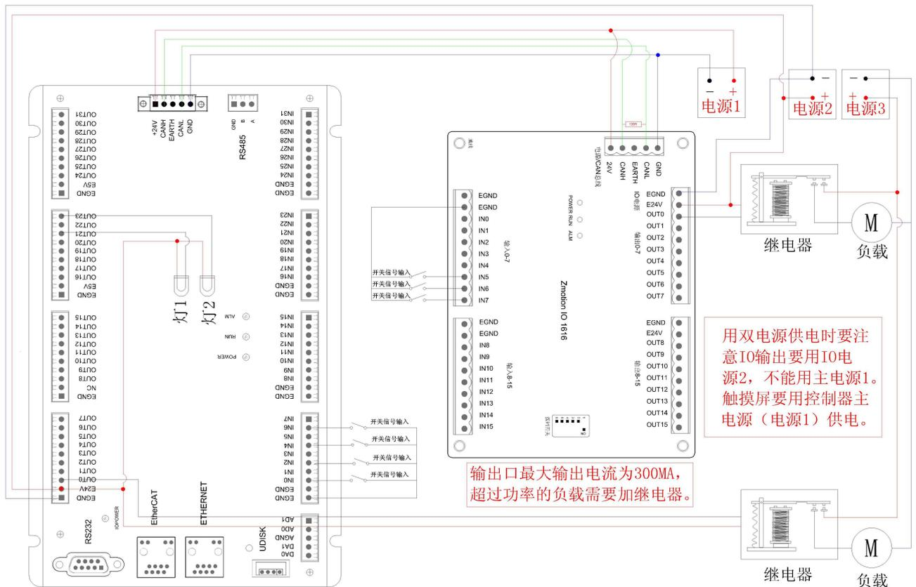
**!** CAN 总线上链接多个 ZIO 扩展模块时，需要在最末端的 ZIO 扩展模块 CANL 与 CANH 端并接一个 120 欧姆的电阻。
