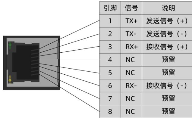
控制器以太网口可以通过一根以太网电缆与计算机，HMI 等进行点对点连接，示意图如下：
