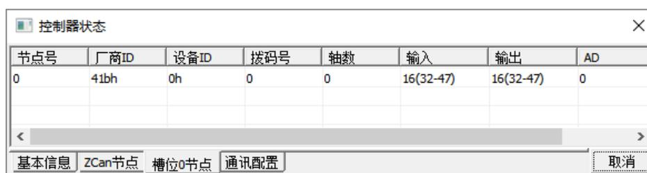
5. 可通过“IN”指令直接读取相应输入口的状态值，也可以通过“ZDevelop/视图/输入口”界面或扩展模块上 IO 指示灯直观查看输入口状态，详细说明见“ZBasic 编程手册”；
