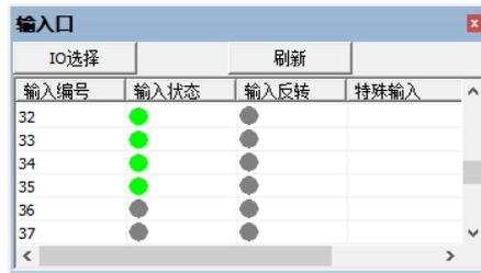
6. 可通过“OP”指令直接操作端口开启或关闭，也可以通过“ZDevelop/视图/输出口”界面直接点击进行开启或关闭，或扩展模块上 IO 指示灯直观查看输出口状态，详细说明见“ZBasic 编程手册”；
