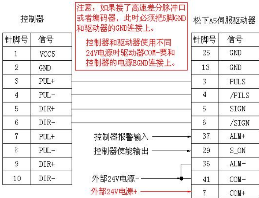
与松下 A5 伺服低速差分脉冲口连接
